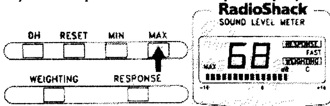
O equipamento mostrará apenas o mais alto nível de medição de ruído durante o período de teste de 1 segundo. (O barragráfico mostra o nível máximo de cada 0,2 segundos ou 0,5 segundos. O segmento barragráfico que corresponde ao pico da leitura fica no display por 2 segundos ou até o equipamento medir o mais alto nível máximo. Pressione Máx novamente para cancelar a medição máxima contínua e retornar a medição média contínua normal).
